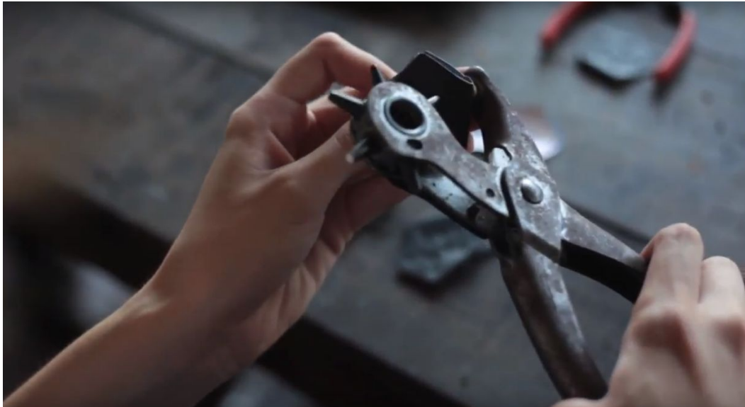
Passo 6 - Furar os conectores com o alicate vazador. Pode empilhar várias camadas para poupar tempo e esforço.
